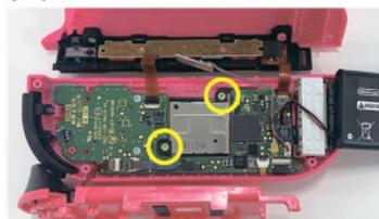
十字ドライバーを使用し、**赤枠部分の2カ所**のネジを外し、スティックを交換します。
