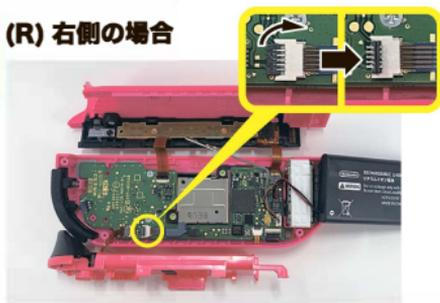
付属のピンセットなどを使用し、**赤枠部分**（右側の場合は**黄枠部分**）の配線を固定する**ストッパーのラッチ**を押し上げ、ストッパーから配線を引き抜きます。
