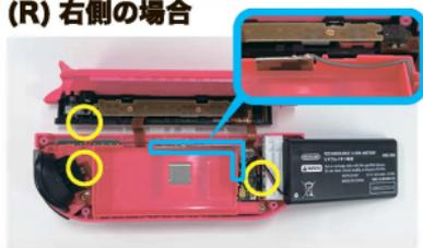
十字ドライバーを使用し、**黄枠部分の3カ所**のネジを外し、**青枠部分の小さな基盤**を外してから、電池が入っていた部分のプレートを開きます。この時も一部配線が繋がっていますので、ゆっくり丁寧に開けてください。
