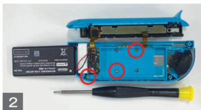
+字ドライバーを使用し、赤枠部分の3カ所のネジを外し、電池が入っていた部分のプレートを開きます。
