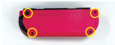
Y字ドライバーを使用し、コントローラー背面の赤枠部分4ヶ所のネジを外します。
