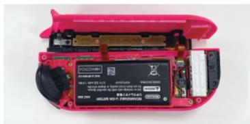
三角型ツールを使用し、両面テープで貼り付いているリチウムイオン電池を丁寧にゆっくり外してください。
